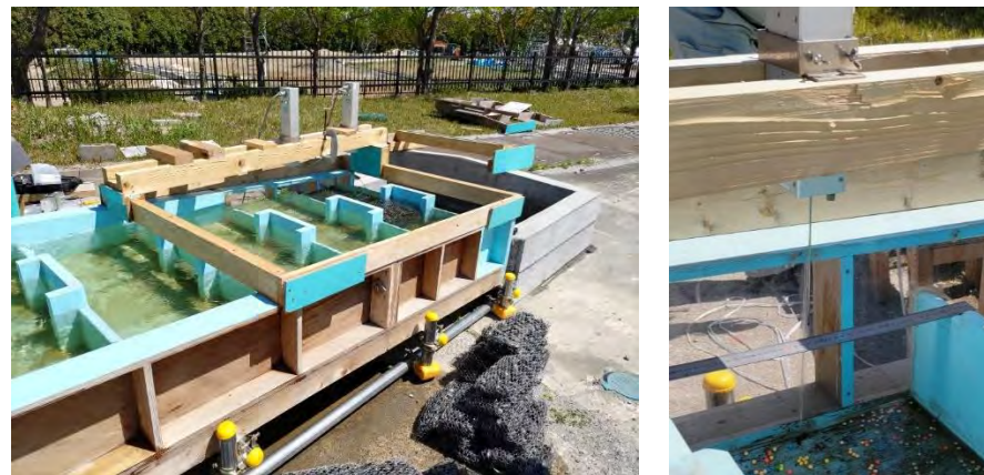
図 2.4.12 サーボ式水位計での計測イメージ
