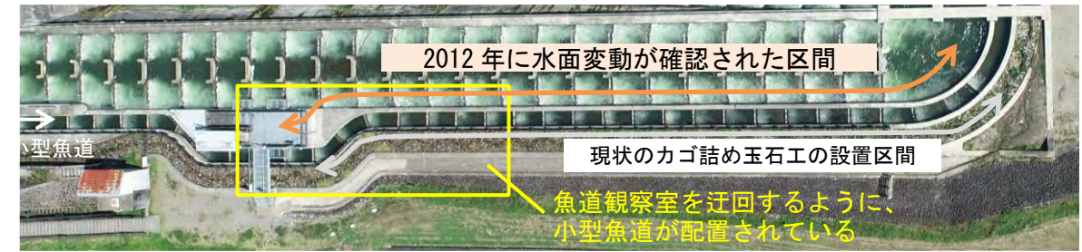
図 2.3.1 小型魚道の平面形状 (①湾曲の魚道平面形状)
