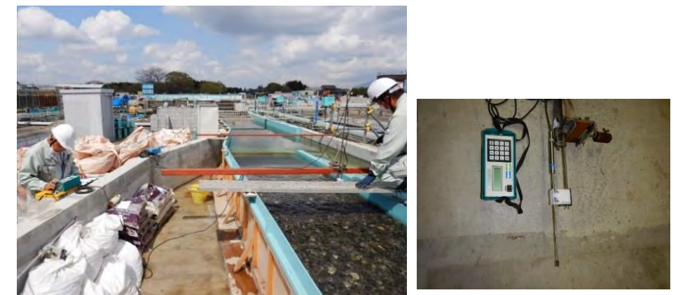
図 2.4.19 電磁流速計による計測イメージ
